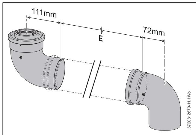
Fig. 7 90° bend offset dimensions
