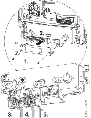
Fig. 35 Wiring detail
