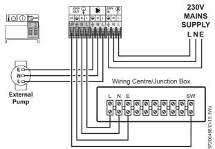
Fig. 48 System wiring centre
