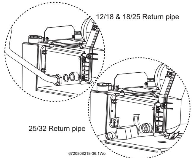
Fig. 41 Return pipes
