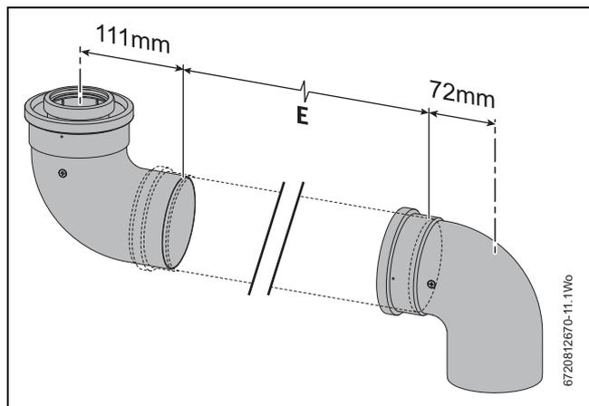
Fig. 7 90° bend offset dimensions
